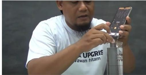
**Gambar 6.** Percobaan menentukan kecepatan suara menggunakan pipa
