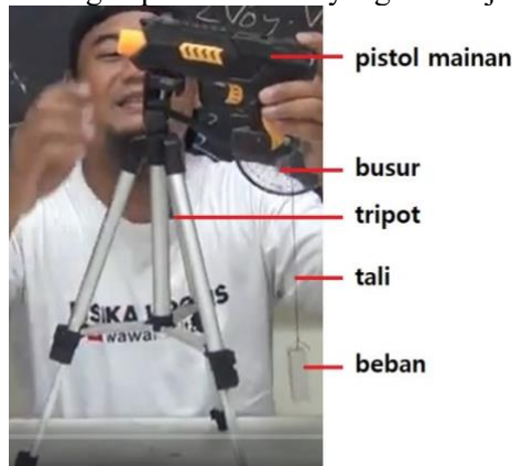
Gambar 4. Rekrayasa pistol mainan untuk dapat mengukur sudut lontara secara mudah
