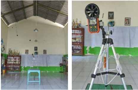
Gambar 3. Digital Anemometer dan Elitech GSP-6 yang dipasang pada ruang utama balai rw (di tengah ruang)
