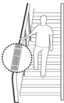
Gambar 4.19. Tangga yang dilengkapi dengan huruf braille di sisi atas dan bawah pegangan rambatan pada interval tertentu yang menunjukkan posisi anak tangga
