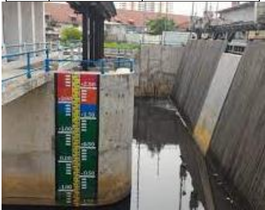
Gambar 1. Pengukuran Level Ketinggian Air (Menggunakan Mistar)
