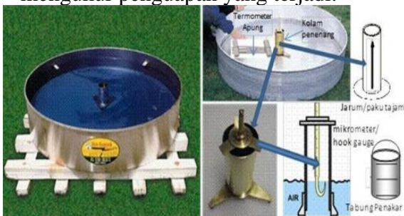
Gambar 6. Alat Panci Penguapan (Pan 'A') dengan Termometer Suhu Air
