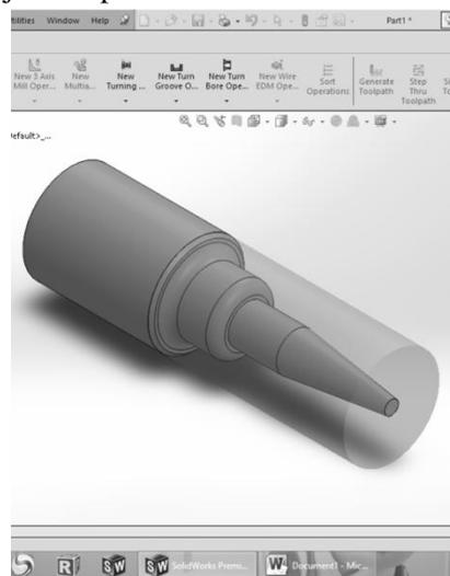
Gambar 4.4 Input stock material  $\varnothing$  30mm dan panjang 100mm.
