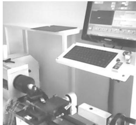
Gambar 4.12Proses pemakanan pahat pada benda kerja mesin CNC bubut.
