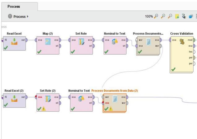
Gambar 5. Diagram sistem menggunakan *k-fold validation*
